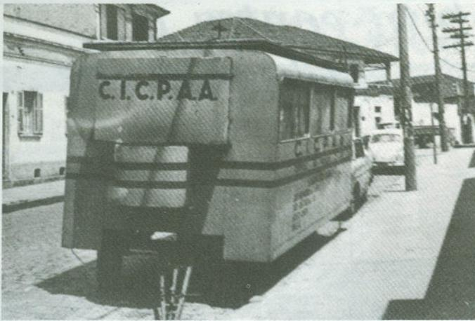
*Laboratório volante a Cicipaa utilizado para amostragens da qualidade do ar e das águas em locais isolados ou por períodos longos de trabalho em áreas inacessíveis ou sem a possibilidade de acesso à Energia Elétrica.*
